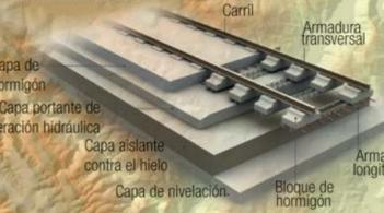
Este tipo de vía aparece con las líneas de alta velocidad. Ofrece una alta calidad de la vía y disminuye los excesivos costes de mantenimiento
