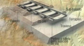
El balasto es el material tradicional para la construcción de vías. Se obtiene por trituración de rocas sanas y debe cumplir ciertas especificaciones
